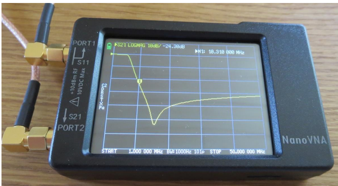
Figur 8. Frekvensgang på 80 m filteret (cursoren er ved 3. harmoniske).
