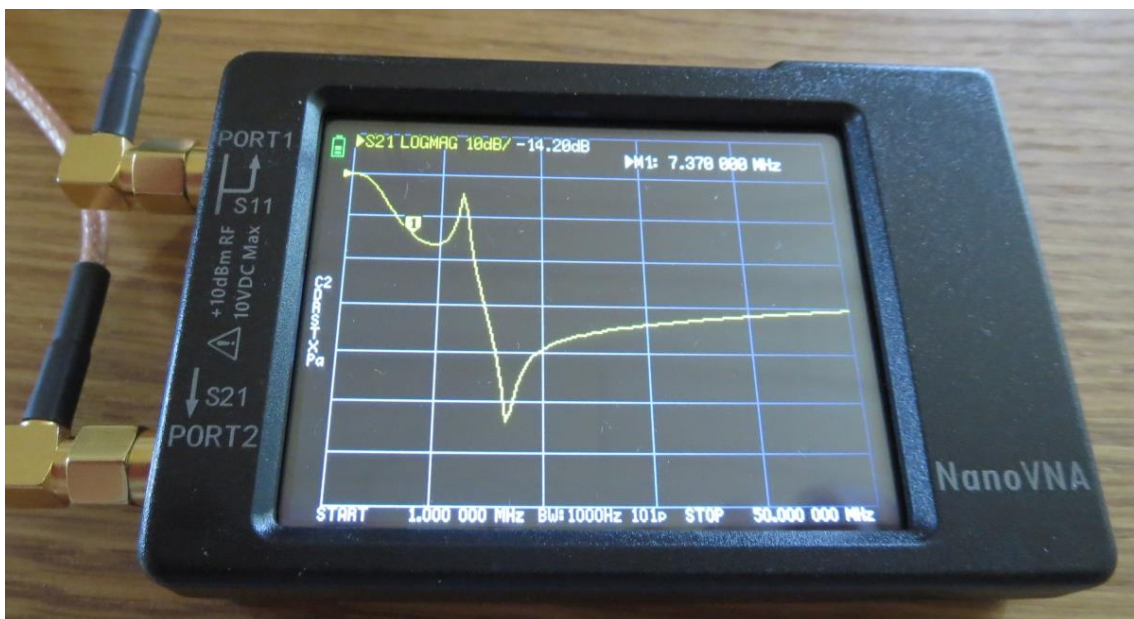
Figur 9. Frekvensgang på 40 m filteret (cursoren er ved grundfrekvensen).
